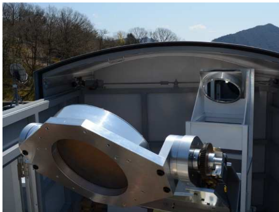
屋上のヘリオスタット部
